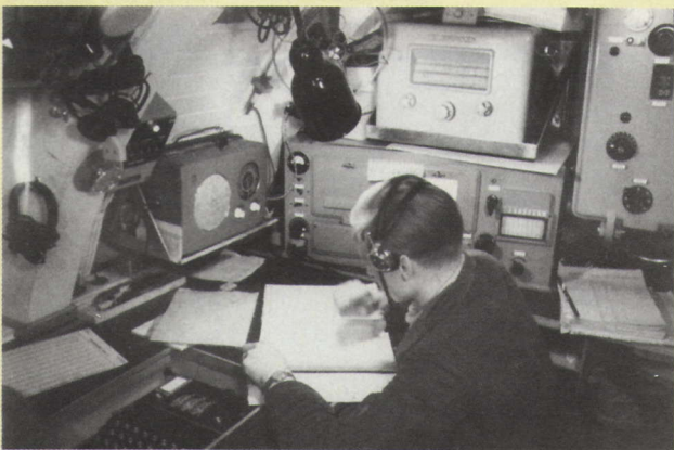
Obr. 9. Vybavení radisty na ponorce U 124 z r. 1941. GW/KW šestiokruhový přímozesilující přijímač 847 S, Ocean Super, Radione R2, zaměřovací přijímač a Enigma M-3
