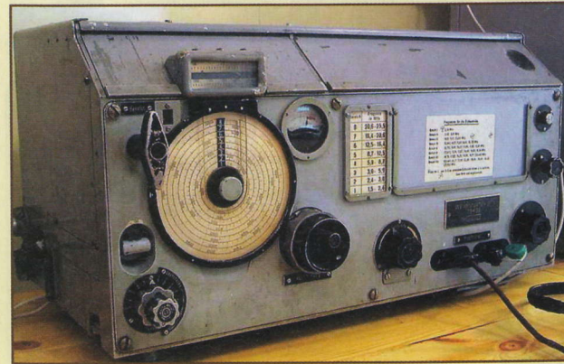
Obr. 18. Tento superheterodyn T9 K 39 „Main“ od firmy Telefunken sloužil pro příjem na KV na lodích, ponorkách a na pevnině
