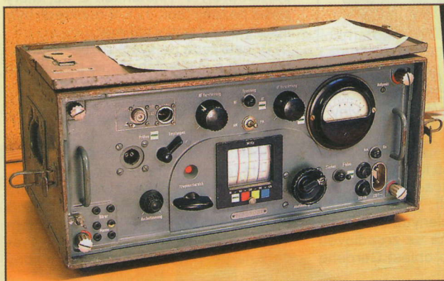
Obr. 15. Měřicí a přehledový superheterodyn „Fanó“ (FuMB 5) RS 1/20 DM43 firmy PTE (R & S) pro příjem v pásmu 400 – 800 (1600) MHz pro varování před radary na ponorkách
