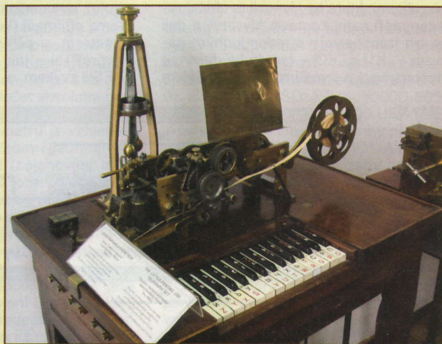
Obr. 4. Ruský model Hughesova přístroje z roku 1900 (výrobce Siemens-Halske) s otevřeným odstředivým regulátorem otáček, vystavený v technickém muzeu v Petrohradě. Za pozornost stojí i dvojnásobně zkomolené jméno vynálezce (Hughes – Juz – Use) na muzejním štítku
