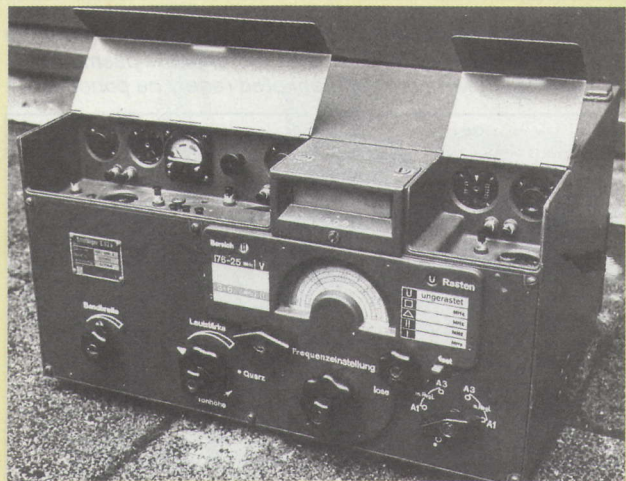
Obr. 12. Superhet Telefunken E 52 („Köln“ T 8 K 44) s rozsahem 1,5 – 25 MHz měl 2 vř předzesilovače, 3 stupně mezfrequenčních zesilovačů, s dvojitým variabilním krystalovým filtrem 0,2 – 10 kHz
